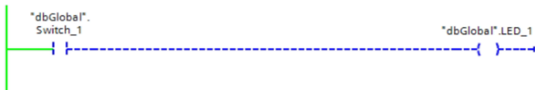
Figur 2.2: Switch_1 falskt medför att LED_1 blir falskt.
